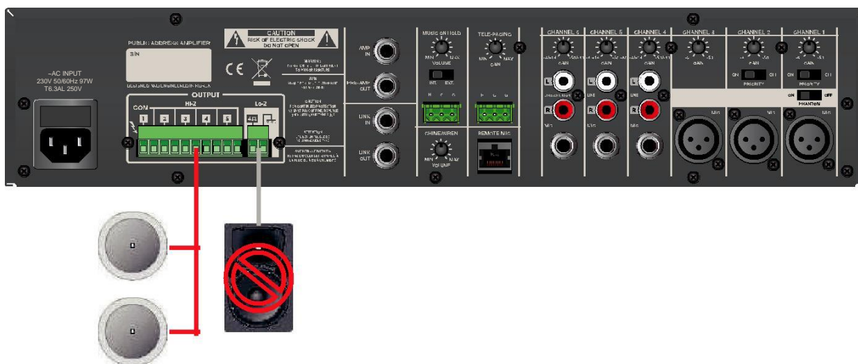
[ Рис. 2.4 Неправильное подключение]
