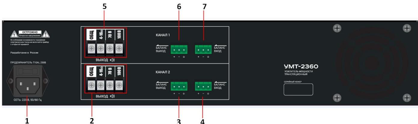
1. «СЕТЬ 220В» - Разъем для подключения кабеля электропитания. В корпусе разъема, находится сменный предохранитель. (Информацию о номинале предохранителя см. на корпусе прибора).
